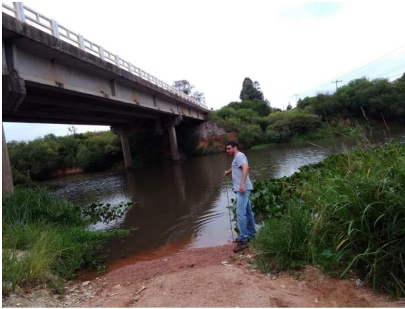
Figura 5 – Coleta de amostra para análise de sólidos em suspensão com o amostrador DH-48. Fonte: Ecossis, 2021.
